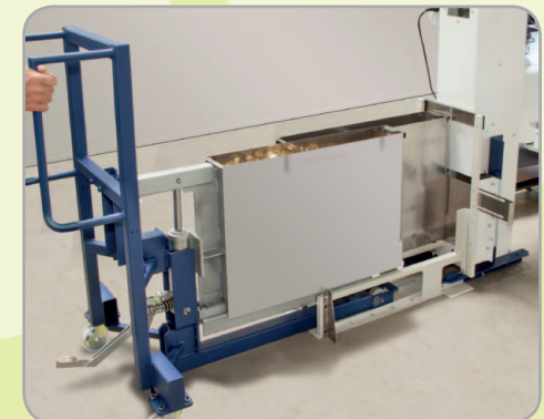
Container auf dem NGZ C31 Fahrwagen an der Dockingstation des Münzlifts
