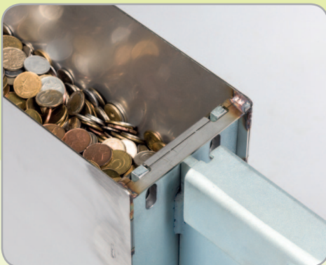
Der Container wird automatisch auf dem Fahrwagen verriegelt
