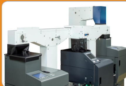
Der Münzlift NGZ 208 kann mit seinen Münzverteilländern bis zu drei Rollierer bestücken
